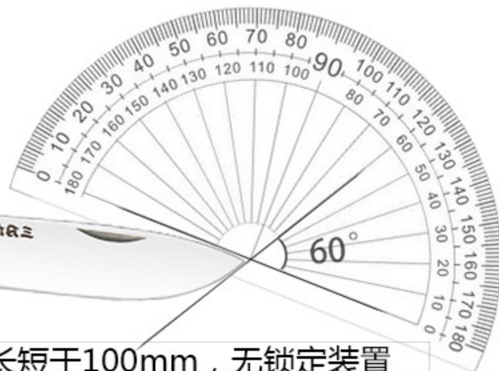
非管制刀具：刀尖角度  $> 60^\circ$ ，刃长短于100mm，无锁定装置
